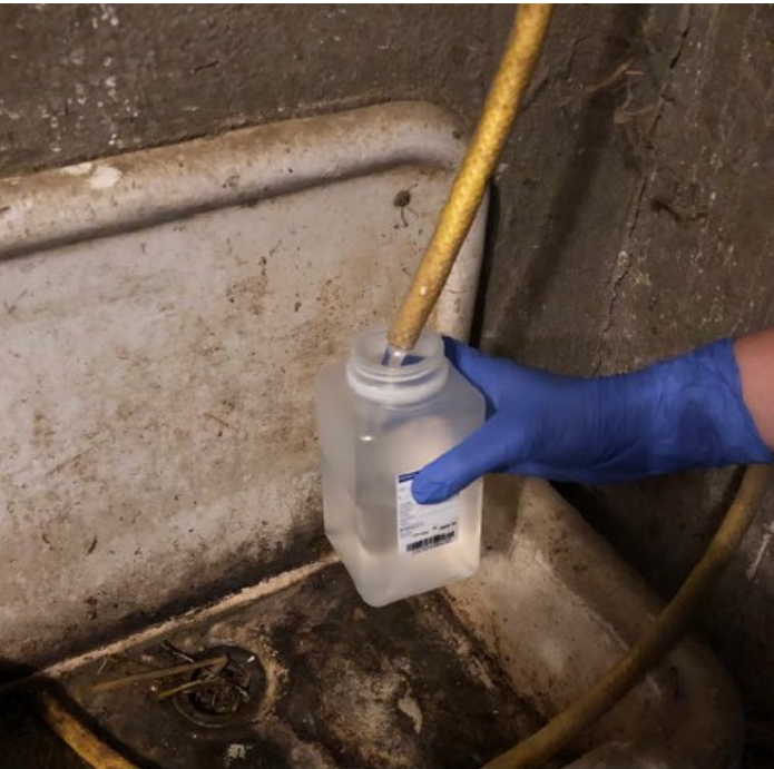
Fig. 2 : Le prélèvement d'échantillons par un tuyau Source de l'image : Laboklin
